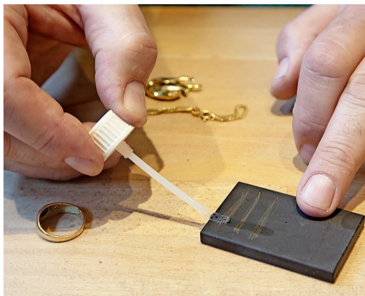
Goldschmied Thomas Peric Schauer sichtet die Prägestempel der Schmuckstücke unter der Lupe und führt danach zur Sicherheit noch einen Säuretest durch. Erst dann kommt das Altgold auf die Waage. Fotos: Sabine Rock
